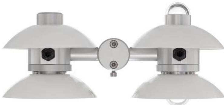
Figura 31. NR01 radiometro netto 4 componenti (pirgeometri a sinistra e piranometri a destra dell'immagine)
