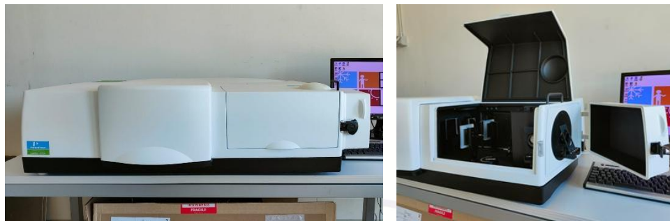
Figura 4. Spettrofotometro PerkinElmer LAMBDA 1050+ UV/Vis/NIR.
