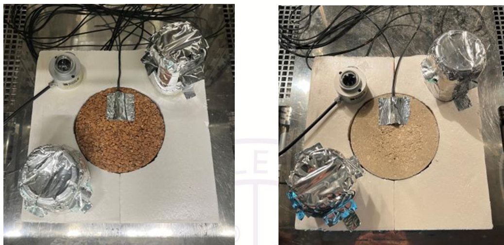
Figura 13. Setup sperimentale: campione all'interno della base isolante e relativi sensori.
